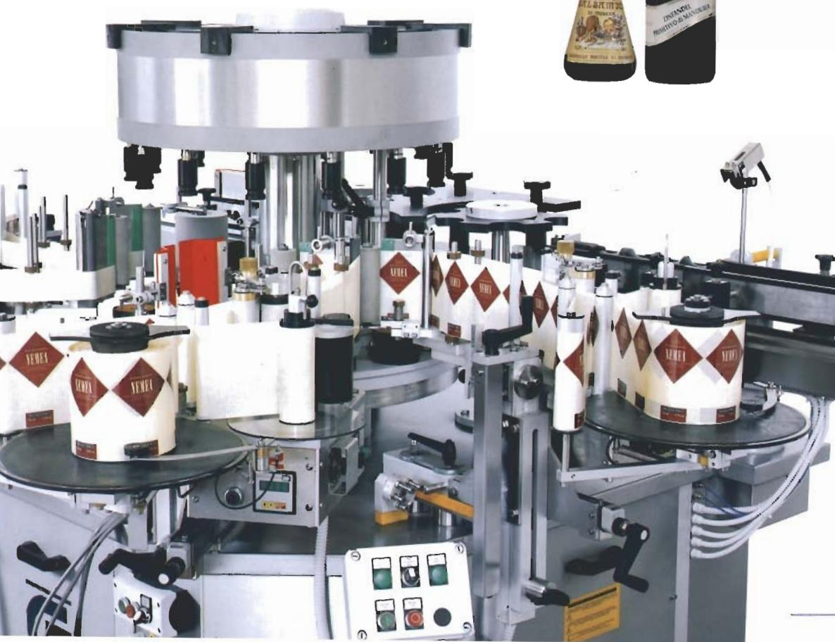
Macchina con stazioni autoadesive di supporto con scambio automatico a fine rullo
